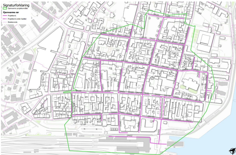
Figur 7.1 Projekterede fjernvarmeledninger HB_K19_F01_H1_205.
